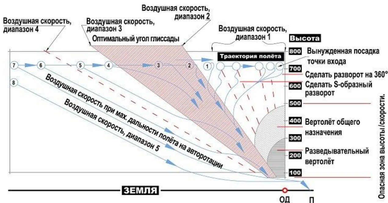
Рис. 3 Области полетных режимов авторотации и посадки для типовых вертолетов.
